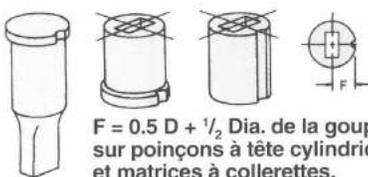
$F = 0.5 D + \frac{1}{2}$  Dia. de la goupille sur poinçons à tête cylindrique et matrices à collerettes.
